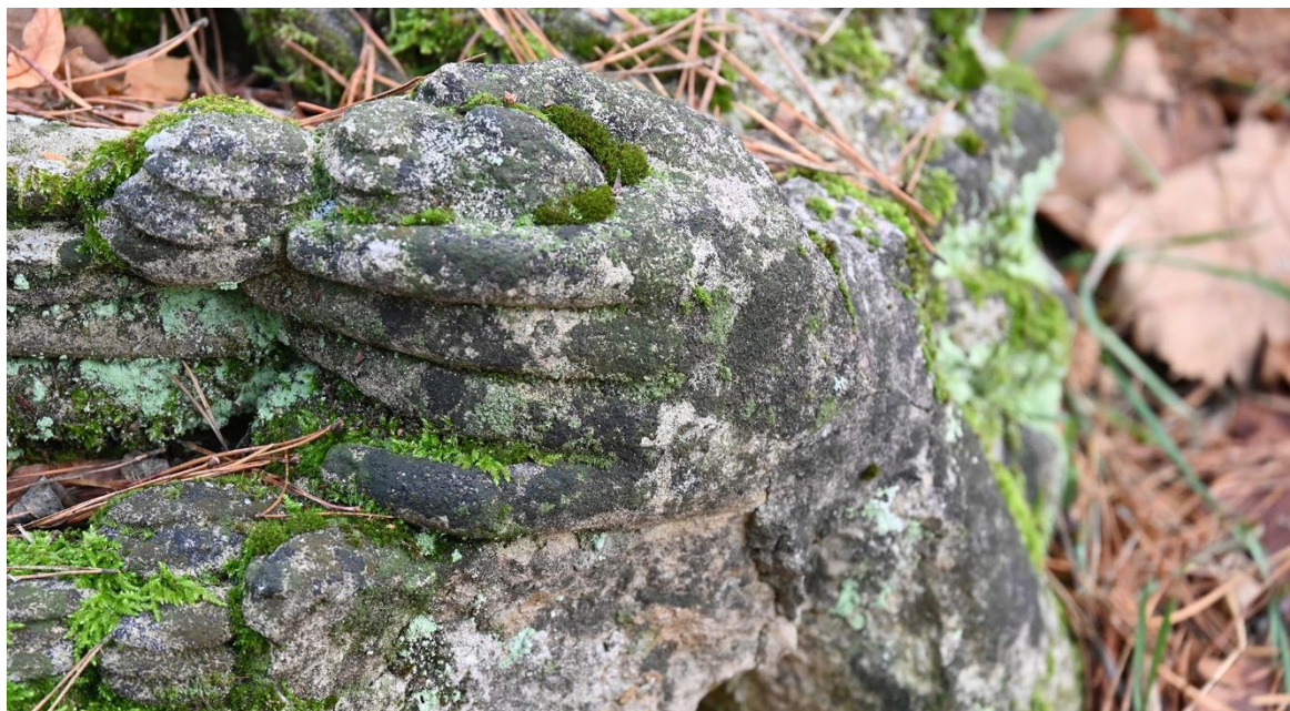
Fot. 13. Zdegradowana powierzchnia kamiennej rzeźby porośnięta mikroorganizmami.
