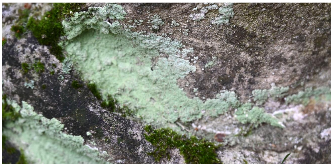
Fot. 14. Zdegradowana powierzchnia kamiennej rzeźby porośnięta mikroorganizmami.
